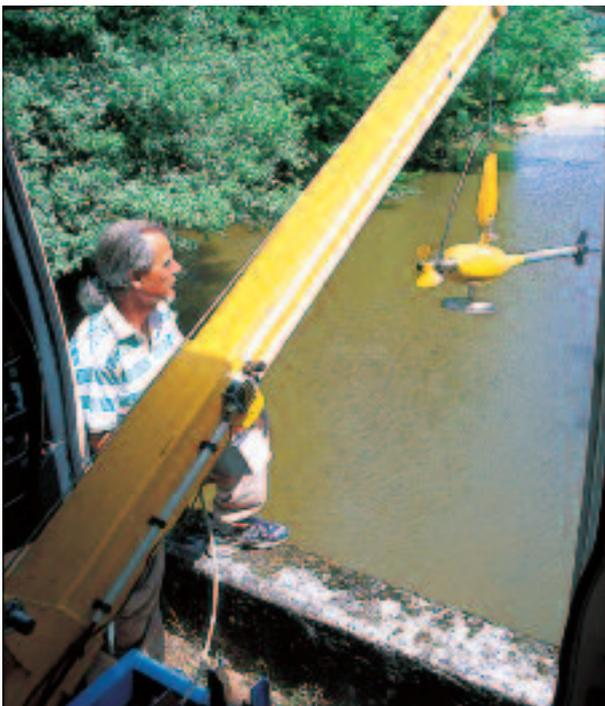
Appareil permettant la mesure de la vitesse du courant.
